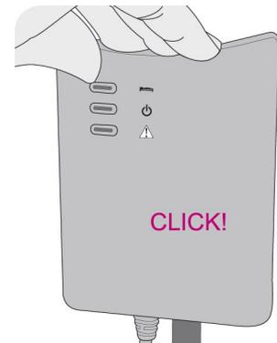
Drücken Sie das Gerät nach unten, bis es mit einem klicken einrastet.
